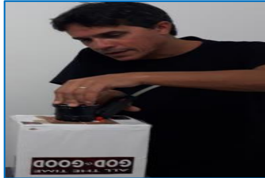
Figura 4.10 – Fixação da lente no tubo de foco
