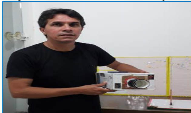
Figura 4.13 – Câmara escura com foco regulável
